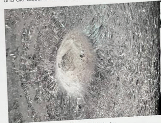
Abb. 01: Beschussprüfung Angriffseite © Yachtglass GmbH & Co.KG
