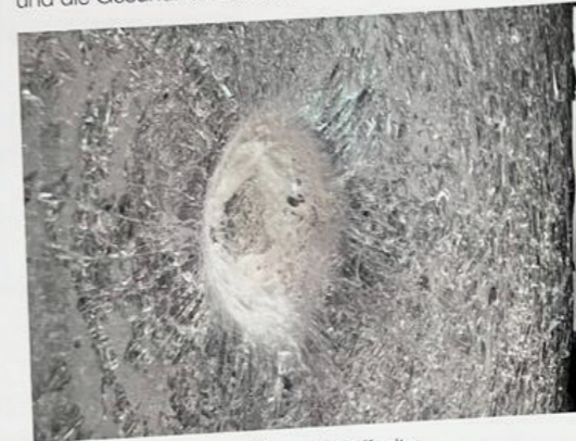
Abb. 01: Beschussprüfung Angriffseite © Yachtglass GmbH & Co.KG
